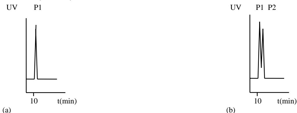
Figura 1 – Analisi HPLC ad esclusione molecolare di mannoproteine estratte con il calore (a) e per digestione enzimatica (b).
